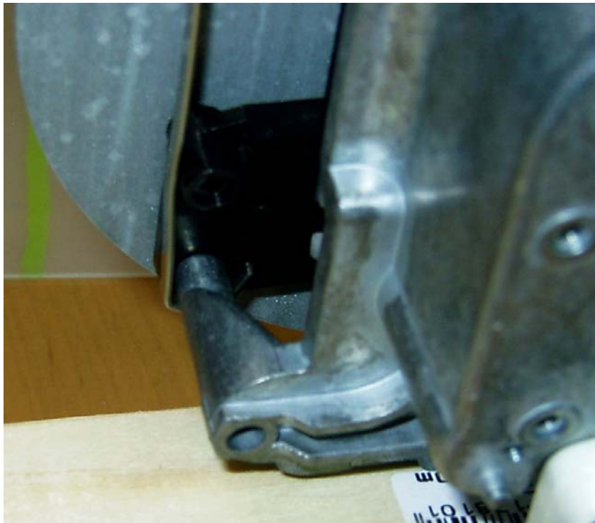
So wird das Ende der Haltemanschette durch Umbiegen gesichert
