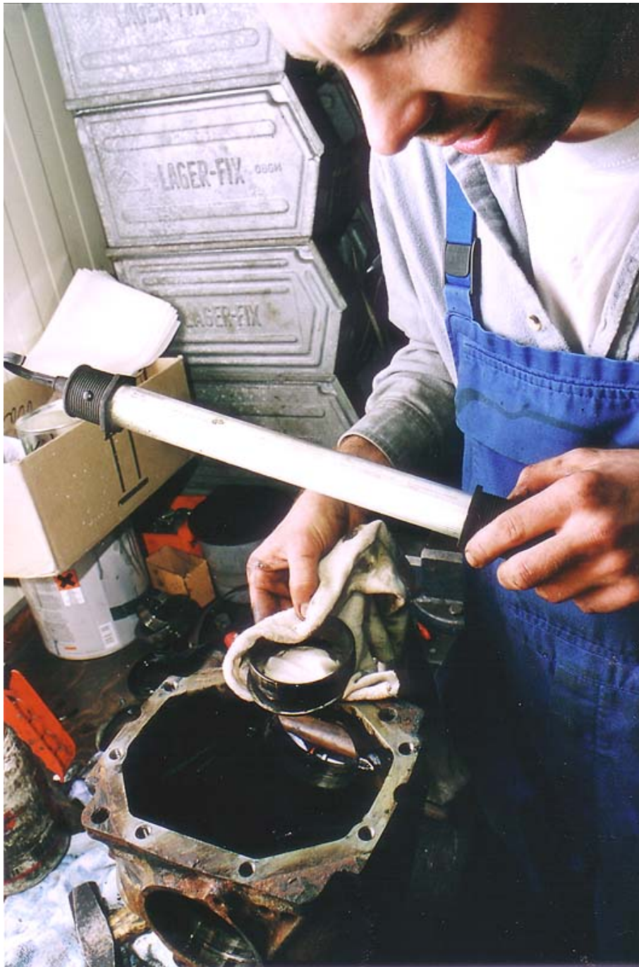
Die Lagerschalen treiben wir mit einem Messingdorn aus
