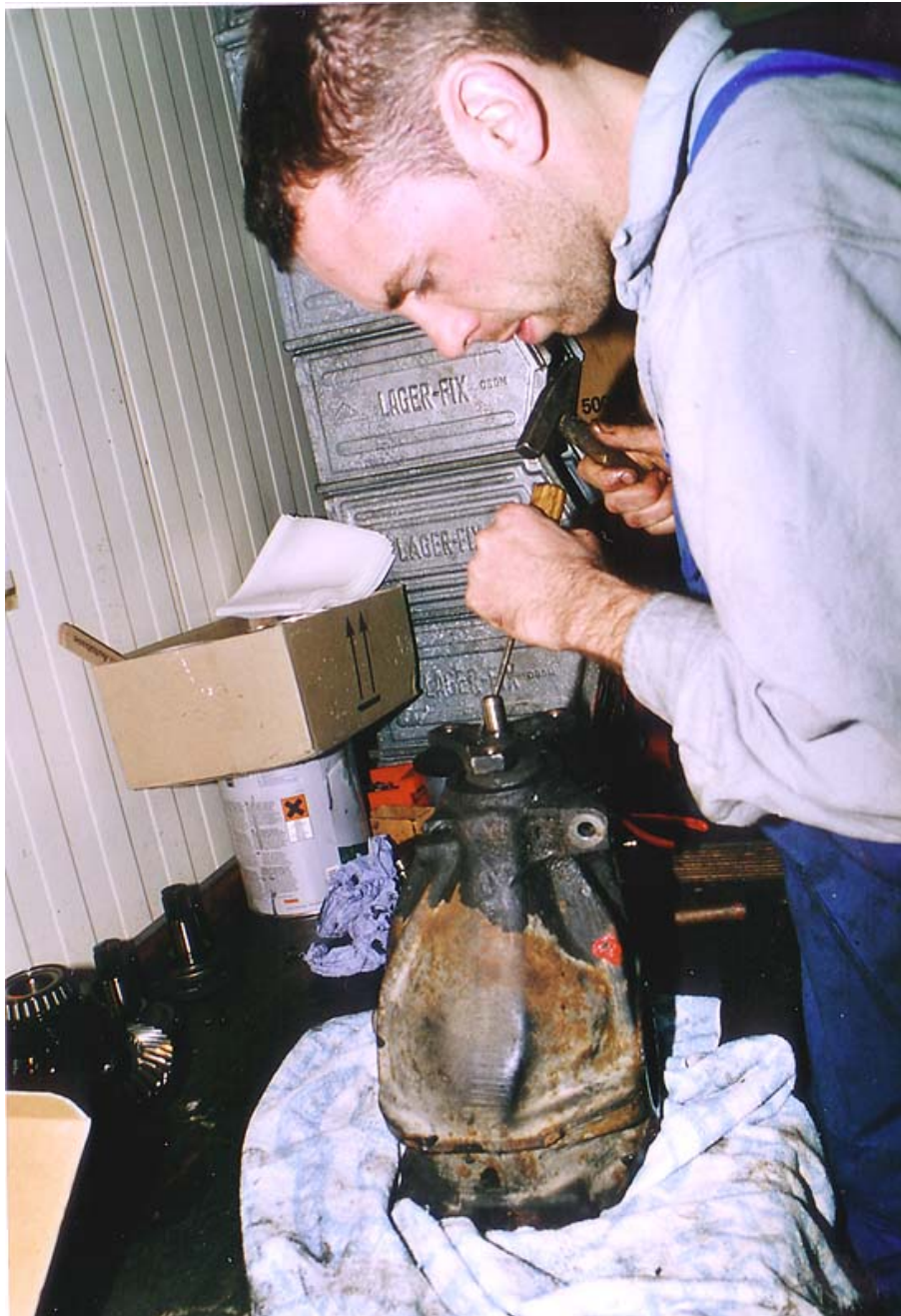
Mutter aufmeißeln. Und wieder wird ein Schraubendreher geschändet!
