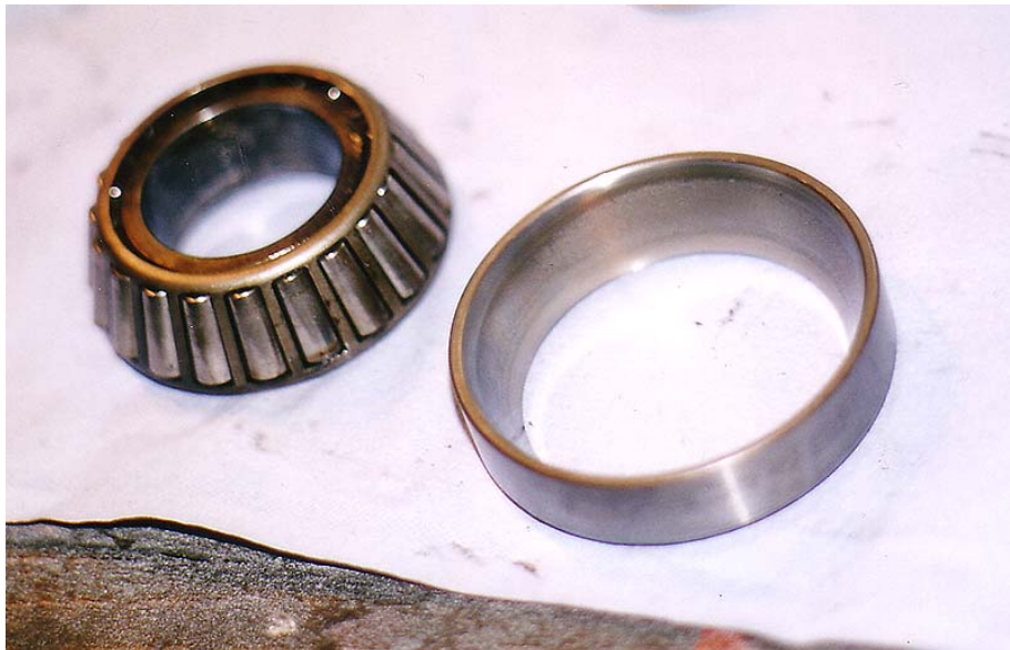
Die Sünderin: Die Schale des Halslagers war vernarbt und hat für das Laufgeräusch gesorgt
