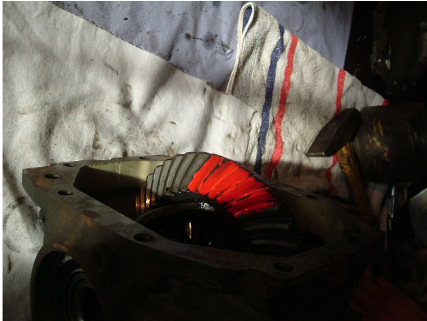
Tellerrad mit Touchierfarbe, kurz vor Einbau
