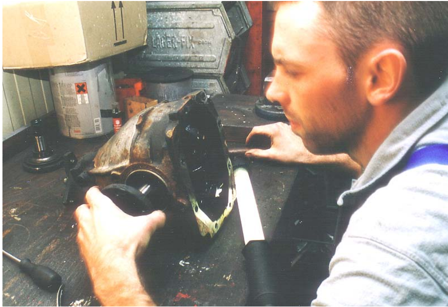
Die Wellenstümpfe seitlich rausziehen
