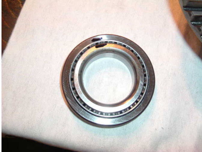
Zugehörige Lagerbestandteile markieren!
